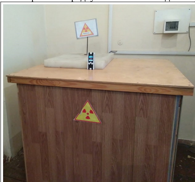
рис. 1. Плутоний-бериллиевый источник нейтронов в защитном блоке из оргстекла, парафина, кадмия и свинца
