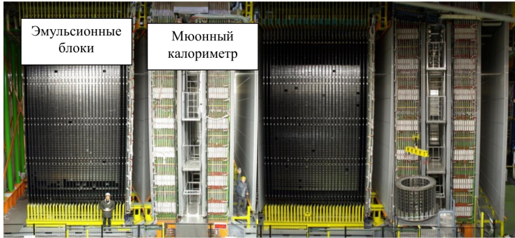
Рис. 1: Фотография детекторной системы эксперимента OPERA
