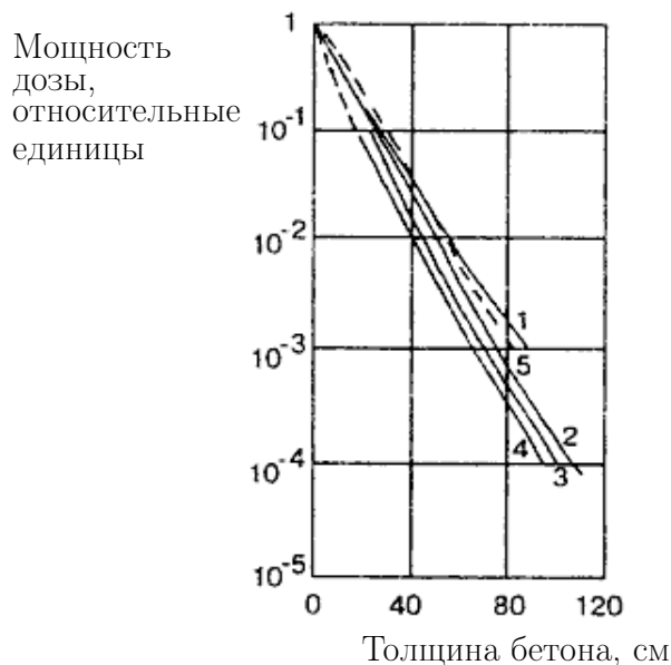
Рис. 3: Кривые ослабления в бетоне гамма-лучей (1), быстрых нейтронов (2), общего потока нейтронов (3), медленных нейтронов (4) и тепловых нейтронов (5).
