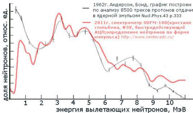
рис.9 Спектр нейтронов Pu-Be источника. E_n > 1\text{кэВ} - быстрые нейтроны; E_n = kT \sim 0,025\text{эВ} - тепловые нейтроны
